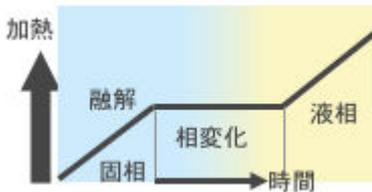
この時に融解に使用した熱エネルギーは、潜熱として PCM に吸収・貯蔵される。逆に、この状態から冷却されると、この貯蔵された潜熱を放出(放熱)するために、周りの温度降下は緩和される。
