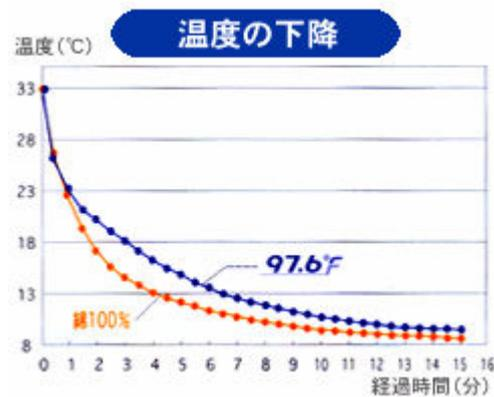
結果: 環境温度を上昇させた場合、試験布 B は、最も早く温度上昇するのに比べ、試験布 A は温度上昇カーブは緩やかとなり、逆に環境温度を下降させた場合、試験布 B は、急激な温度低下をするが、試験布 A は、温度下降カーブが緩やかとなり、97.6° F を用いることで急激な温度変化に対して緩衝作用があることがわかります。
